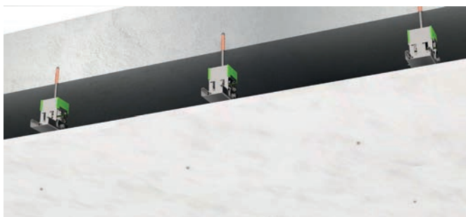
13.- Fixation des plaques de plâtre.
